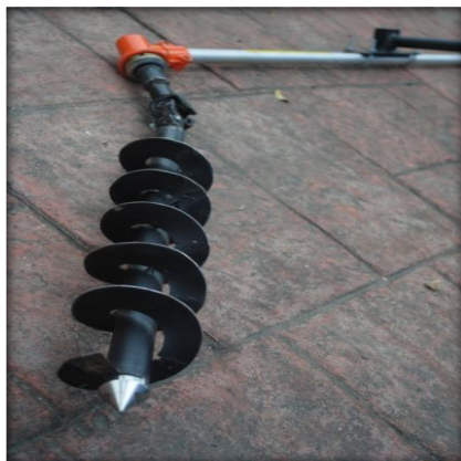
Rajah 8. Gerudi gerimit yang telah dipasangkan kepada mesin rumput bagi menghasilkan SDe
