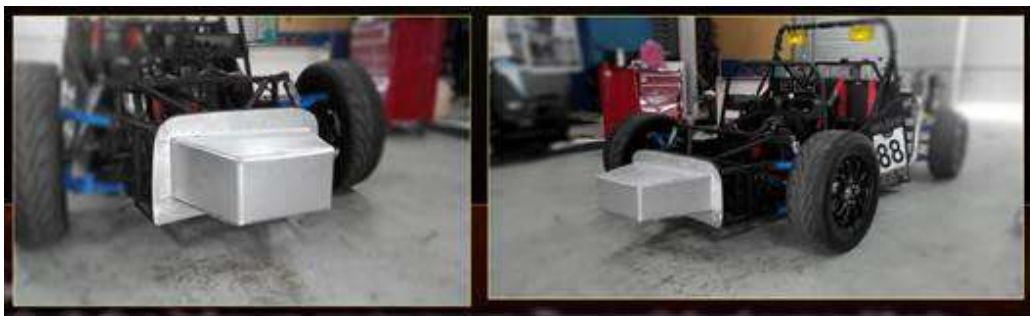
Rajah 15. Pemasangan “Crash Box” Pada Jentera Perlumbaan
