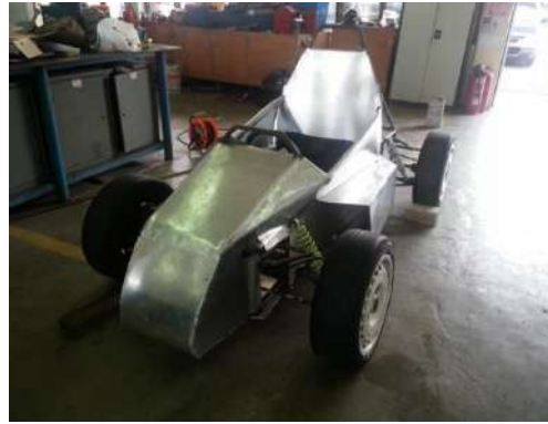
Rajah 15. Proses penyesuaian komponen dan penutup badan
