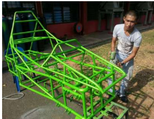
Rajah 16. Proses cat anti karat dan lapisan perlindungan
