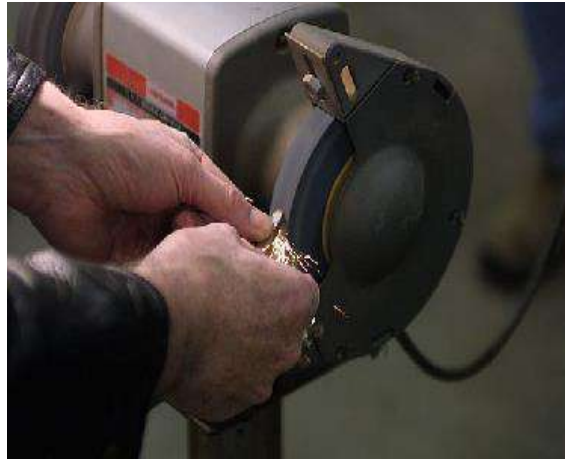
Rajah 2. Proses Mencanai Mata Alat Secara Offhand Sumber: http://www.valley-metal.org
