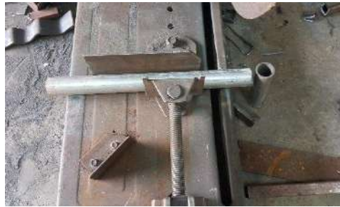
Rajah 1. GI paip dipotong mengikut saiz
