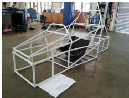
Rajah 14. Model ukuran sebenar ( mock up ) kerangka untuk penyesuaian rekabentuk
