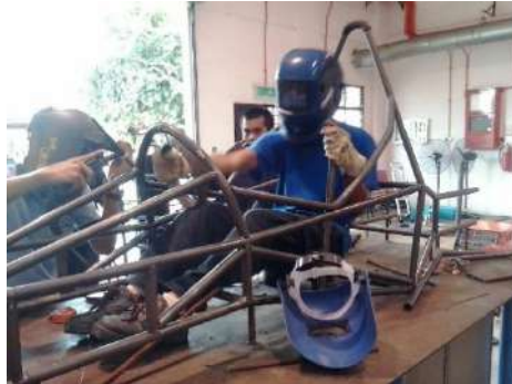
Rajah 8. Model ukuran sebenar ( mock up ) kerangka untuk penyesuaian rekabentuk
