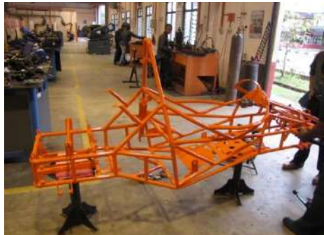
Rajah 10. Proses cat anti karat dan lapisan perlindungan
