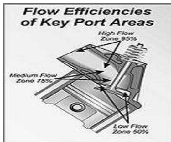
Rajah 2. Sistem Aliran Dalam Kebuk Pembakaran
