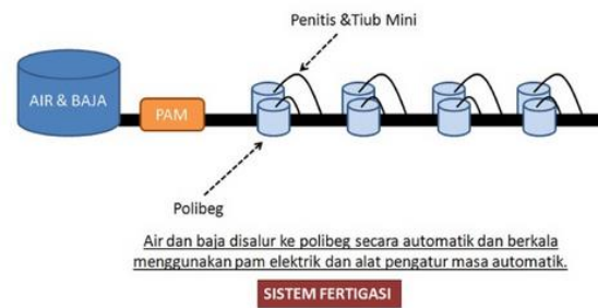
Rajah 1: Kaedah penyiraman cara fertigasi
