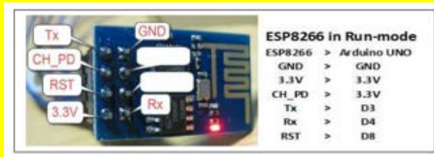
Figure 3.10.5 : Wiring For ESP8266
